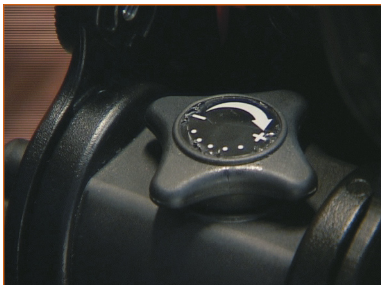
5.36 À vous de serrer ou de desserrer les frictions du pied.
