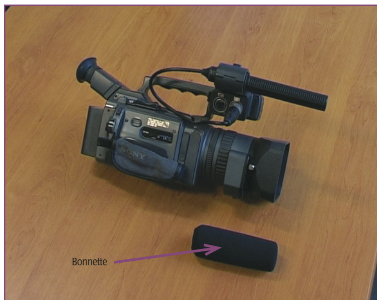
4.1 La bonnette en mousse protège le micro des bruits générés par le vent.
