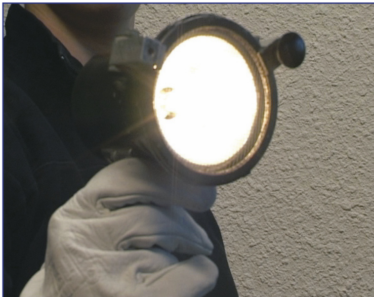
1.17 En général une minette permet un éclairage d'appoint de couleur chaude (3 200 K).
