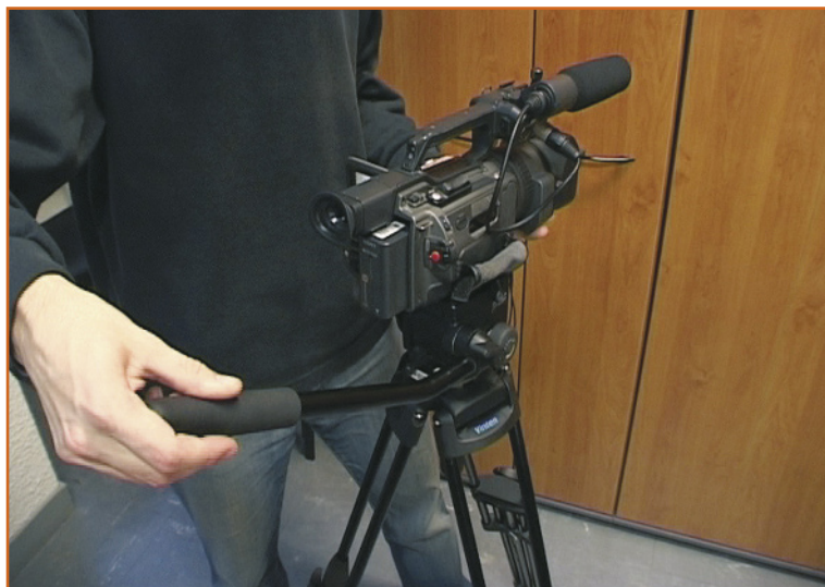
5.34 Pour avoir une rotation horizontale fluide.
